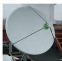
АППИ-М – станция приема данных с геостационарных КА серии Электро-Л в международном формате LRIT в L-диапазоне. Диаметр антенны 1,65 м.
