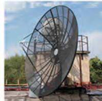
СПОИ-2С – станция приема и обработки данных с геостационарных КА в С-диапазоне. Станция СПОИ-2С позволяет принимать информацию с японских геостационарных КА Himawari-8/9 в международном формате LRIT. Диаметр антенны 3 м.
