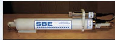
Прибор измерения волнения и приливов
