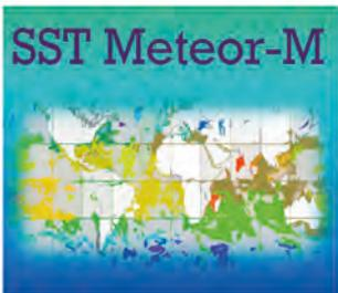
ПК тематической обработки предназначен для определения температуры поверхности Мирового океана (ТПО) по данным МСУ-МР КА серии Метеор-М. В набор опций ПК дополнительно входит расчет регулярных сеток с усреднением значений в ячейках, оценка точности получаемых значений и построение глобальных карт ТПО.
